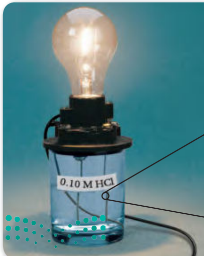
الشكل 2-11 يتوهج المصباح بقوة عندما يوضع القطبان في محلول حمض الهيدروكلوريك بتركيز 0.10\text{ M} ؛ لأن جميع HCl تتحلل إلى أيونات هيدرونيوم وأيونات كلوريد.
