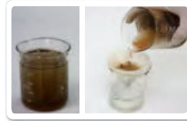
الشكل 1-1 يمكن فصل المخلوطة المعلقة إذا تركت دون تحريك فترة من الزمن، أو فصلها بالترشيح.
