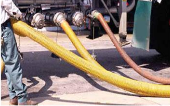
لاحظ أسلاك التأريض قبل تفريغ النفط أو الغاز
