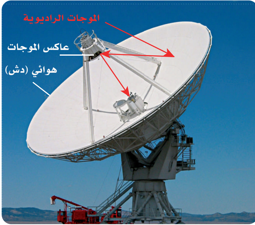
الشكل 14-3 تركيب المنظار الراديوي.
