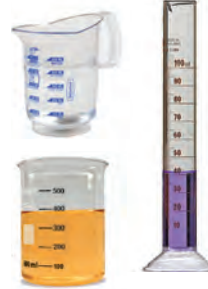
▲ تقاس حجوم السوائل باستخدام المخارير المدرجة، والدورق أو الكأس المدرج.
