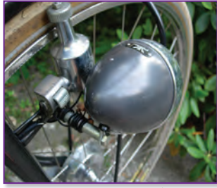
يتصل المولد الكهربائي بعجلة الدراجة
