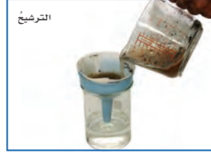
الترشيح عند إضافة الماء إلى ملح ورمل يذوب الملح في الماء ولا يذوب الرمل. يمكن استخدام مرشح لفصل الرمل عن الماء.
