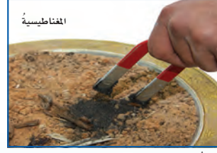
المغناطيسية يفصل المغناطيس برادة الحديد عن المواد غير المغناطيسية.
