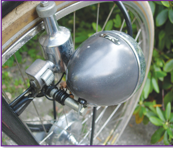
يتصل المولد الكهربائي بعجلة الدراجة
