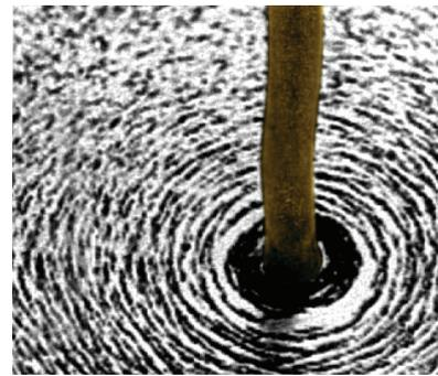
توضّح برادة الحديد خطوط المجال المغناطيسي حول سلك يسري فيه تيار.
