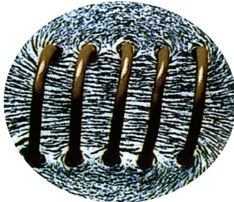
ب يصبح المجال المغناطيسي قوياً عند لف السلك الذي يسري فيه التيار، على شكل ملف لولبي (حلزوني).
