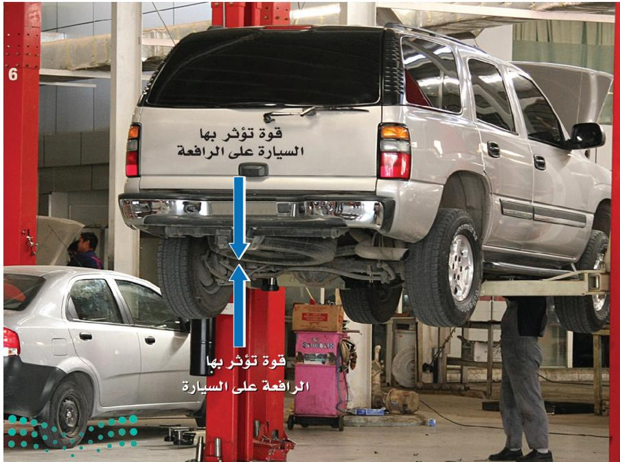
الشكل ١٢ تدفع الرافعة السيارة إلى أعلى، بالقوة نفسها التي تدفع بها السيارة الرافعة إلى أسفل.
