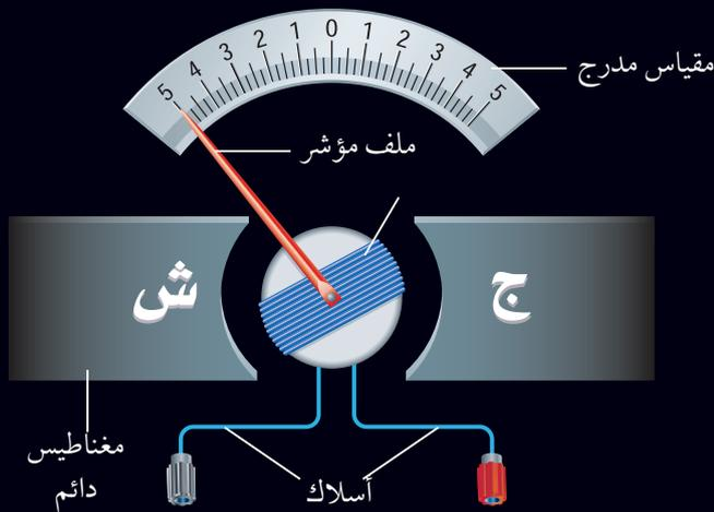
يوجد في الجلفانومتر مؤشر يتصل مع ملف قابل للدوران، بين قطبي مغناطيس دائم، وعندما يتدفق التيار الكهربائي في الملف يصبح الملف مغناطيسًا كهربائيًا، وتنشأ قوى تجاذب وتنافر بين أقطاب الملف وأقطاب المغناطيس الدائم، تؤدي إلى دوران الملف بمقدار يتناسب مع مقدار التيار الكهربائي المار فيه.
