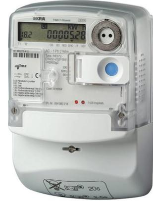
**الشكل ١٤** عداد كهرباء يقيس كمية الطاقة الكهربائية المستهلكة بوحدة كيلوواط. ساعة.
