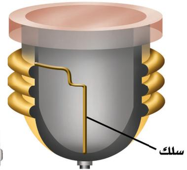
يحتوي المنصهر على سلك فلزي رفيع، ينصهر عندما يزيد التيار عن مقدار معين، وبذلك تنقطع الدائرة الكهربائية.
