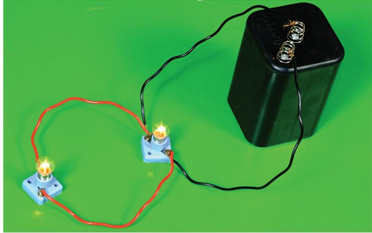
**الشكل ١٢** تمثل هذه الدائرة طريقة التوصيل على التوازي التي تتضمن أكثر من مسار لتدفق التيار.
