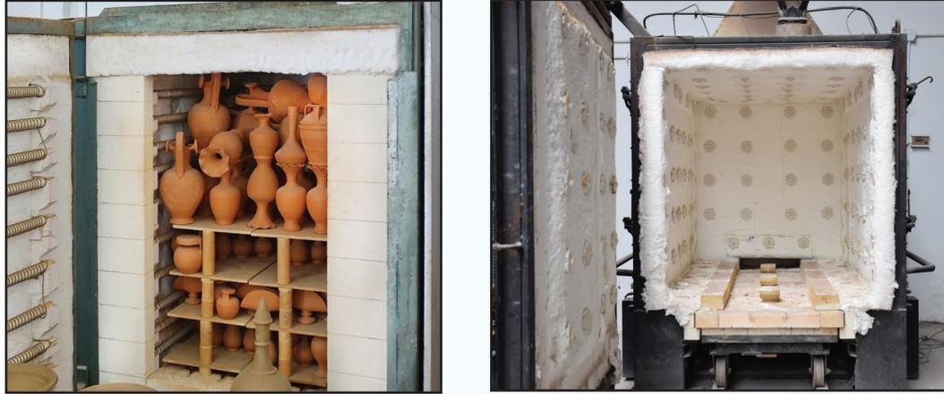
شكل (٦٣): الأفران الكهربائية.
