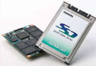
شكل (6-11): نموذج للقرص الصلب الإلكتروني (SSD, Solid State Drive)
