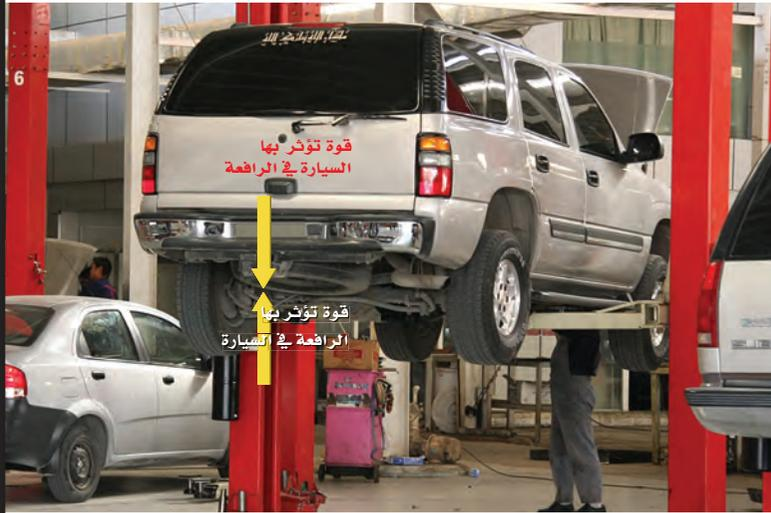
الشكل ١٣ تدفع الرافعة السيارة إلى أعلى، بالقوة نفسها التي تدفع بها السيارة الرافعة إلى أسفل.
