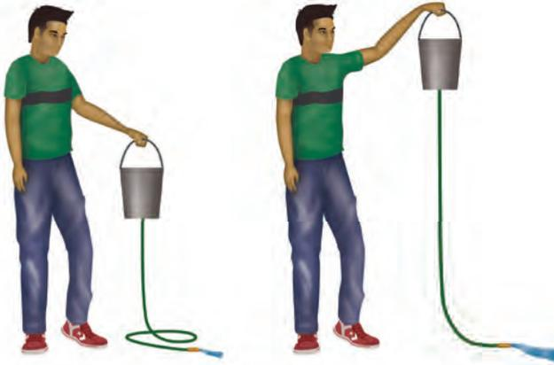
الشكل ٨ عند رفع الدلو إلى أعلى يزداد مقدار طاقة وضع الماء داخله، مما يُسبب زيادة سرعة تدفق الماء الخارج من الخرطوم.
