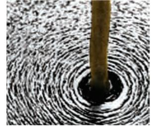
١ توضح برادة الحديد خطوط المجال المغناطيسي حول سلك يسري فيه تيار.
