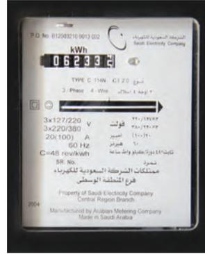
**الشكل ١٢** عداد كهرباء يقيس كمية الطاقة الكهربائية المستهلكة بوحدة كيلو واط. ساعة. **تعرف** عداد الكهرباء المركب في منزلك.
