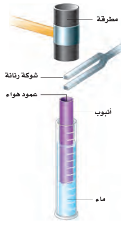
■ الشكل 8-8 يغير رفع الأنبوب أو إنزاله، طول عمود الهواء، ويكون الصوت عاليًا عند حدوث رنين بين عمود الهواء والشوكة الرنانة.
