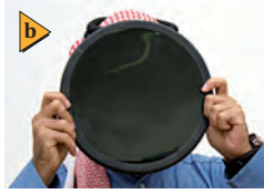
الشكل 18-9 عندما يتم ترتيب مرشحي استقطاب بحيث يكون محورا استقطابيهما متوازيين، تنفذ من خلالهما أكبر كمية من الضوء (a). ولن ينفذ الضوء من خلال مرشحي الاستقطاب إذا تم ترتيبهما بحيث يكون محورا استقطابيهما متعامدين (b).
