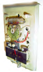
■ الشكل 22-6 في منظم الحرارة (الترموستات) المبين هنا، يتحكم شريط حلزوني الشكل مصنوع من فلزين (مزدوج حراري) في تدفق الزئبق لفتح الدوائر الكهربائية وإغلاقها.
