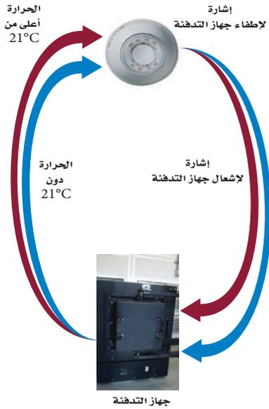
■ الشكل 14-7 ينظف نظام التدفئة المركزية أو يشتعل بناءً على العلاقة بين درجة الحرارة التي يتم رصدها ودرجة الحرارة المرجعية (التي تم ضبطها).
