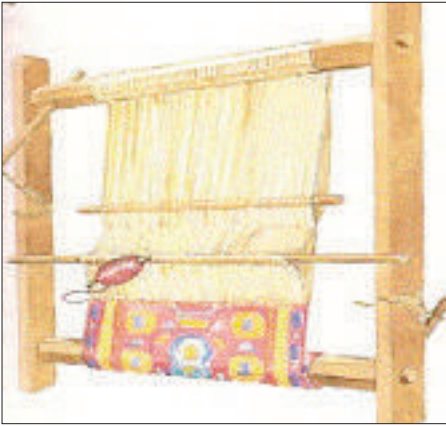
الشكل (٧٩): نول الكليم ويلاحظ فيه تباعد خيوط السدى بما يتناسب مع التصميم المرسوم.
