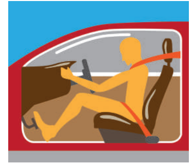
■ الشكل 4-7 يندفع قائد المركبة بشدة نحو الأمام في السيارة التي تسير بسرعة متجهة ثابتة في حالة التوقف المباشر.
