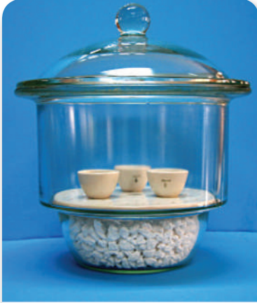
الشكل 18-5 يجفف كلوريد الكالسيوم الهواء من جزيئات الماء. كما يستعمل في المختبر في حفظ المواد الكيميائية من رطوبة الجو.
